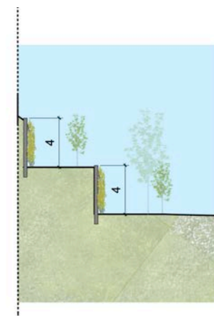
Option 3 : Murs de soutènement
